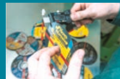
Візуальний контроль всіх геомет- ричних розмірів круга
