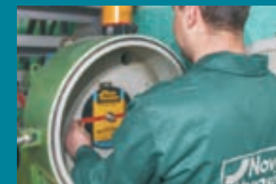
Тест на безпеку - випробування на розрив круга
