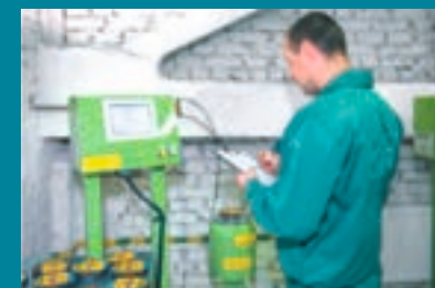
Перевірка дисбалансу та ваги абразивного круга
